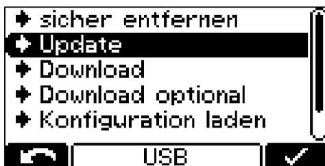
3. Das Update startet nach Auswahl automatisch und darf nicht unterbrochen werden, z.B. durch Abschalten der Versorgungsspannung.
