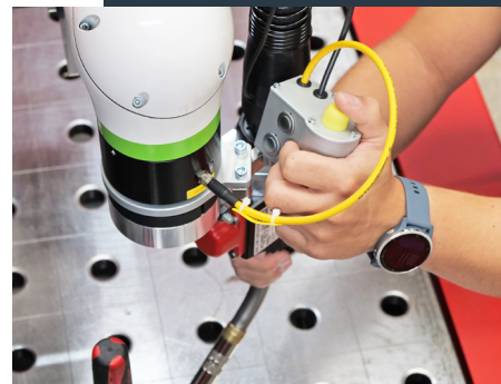
Programación sencilla de la trayectoria de soldadura mediante guiado directo de la antorcha
