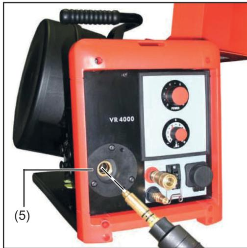
Schweißbrenner in Anschluss für Tweco ein-
