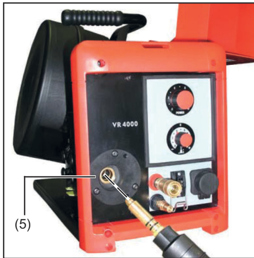
Hegesztőpisztoly betolása a Tweco csatlakozóba
