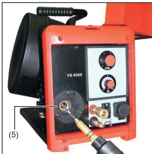
Wsuwanie palnika spawalniczego w przyłącze do Tweco
