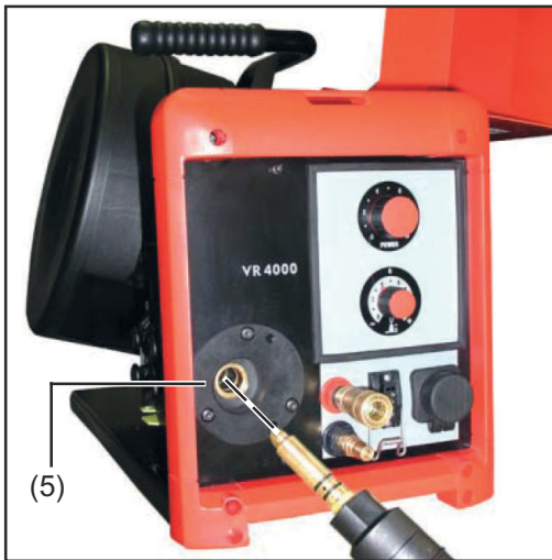
Introduceți pistolul de sudare în racordul pentru Tweco
