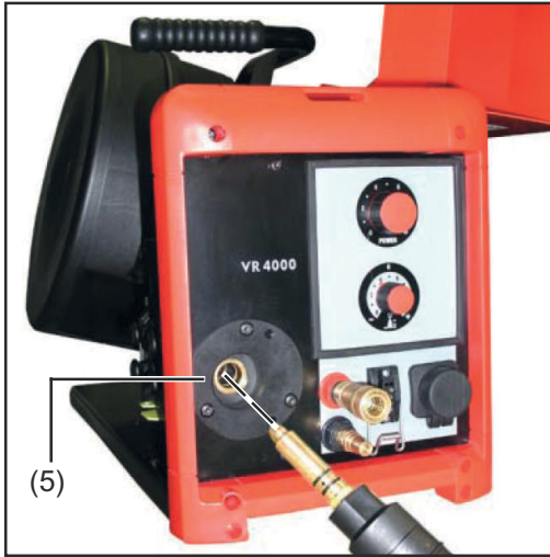
将焊枪插入 Tweco 接口
