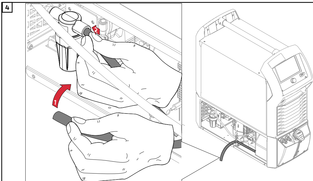
Zasunutí hadice chladicího média do předfiltru chladicího média
