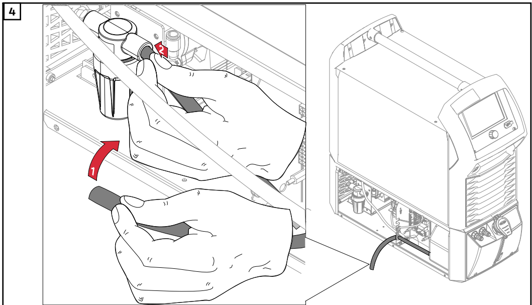
Kühlmittel-Schlauch in den Kühlmittel-Vorfilter stecken
