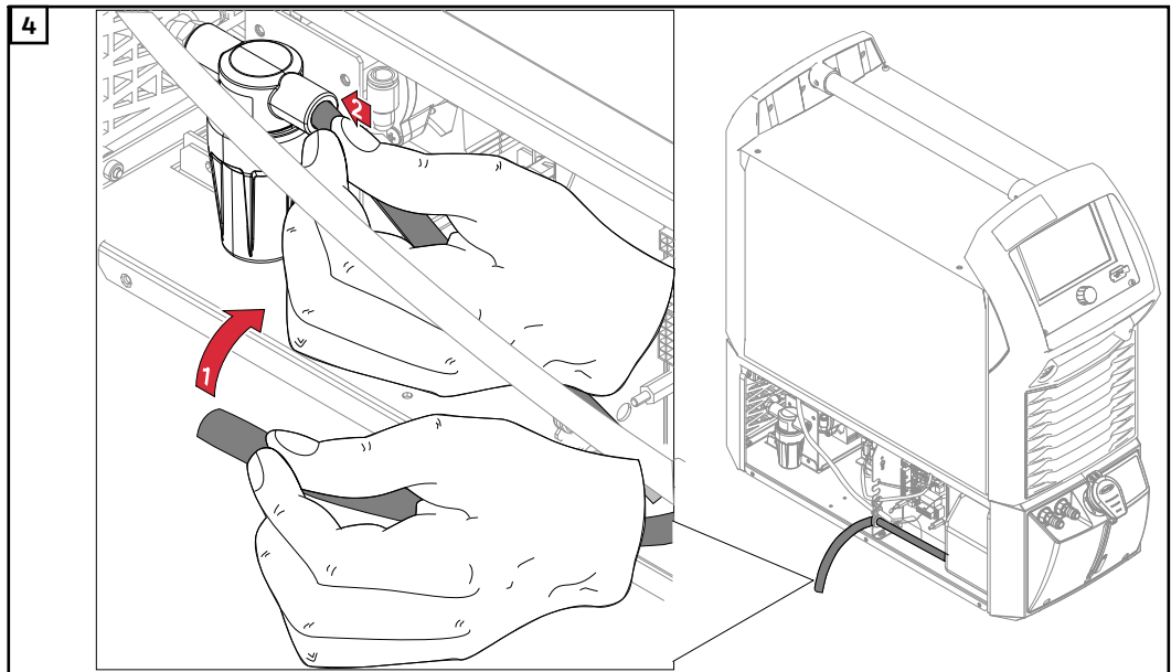
Inserire il tubo del refrigerante nel prefiltro del refrigerante.
