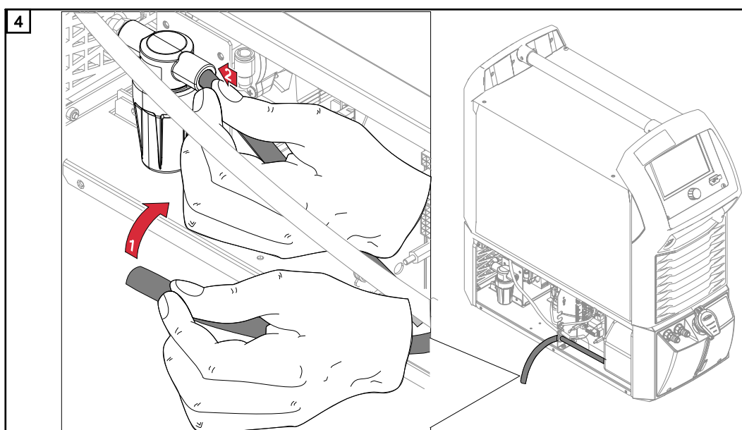
Introducerea furtunului pentru lichid de răcire în filtrul preliminar pentru lichid de răcire
