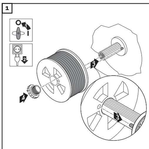
Insérer la bobine de fil : sur un appareil D300
