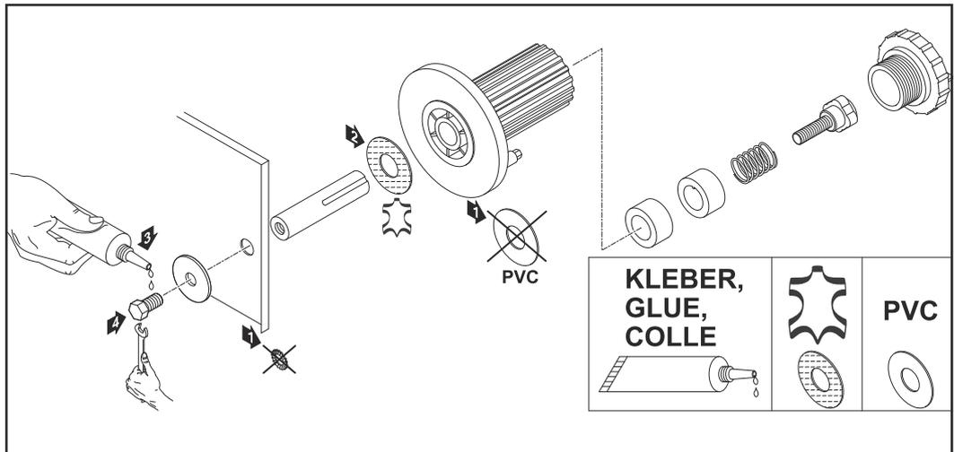
Mise en place du frein : sur un appareil D300
