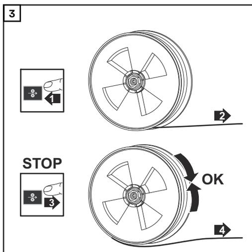
Mise en place du frein : sur un appareil D200
