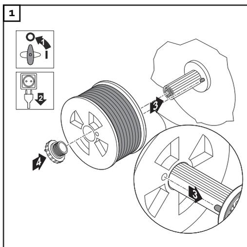
**Inserir bobina de arame: no aparelho D300**
